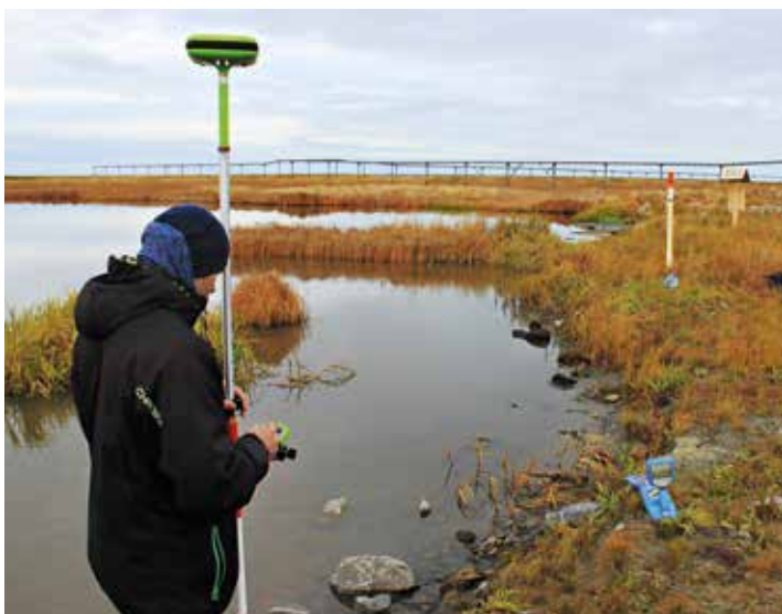
Рис. 1 – Проведение геокриологического мониторинга на магистральном газопровode «Бованенково – Ухта».
