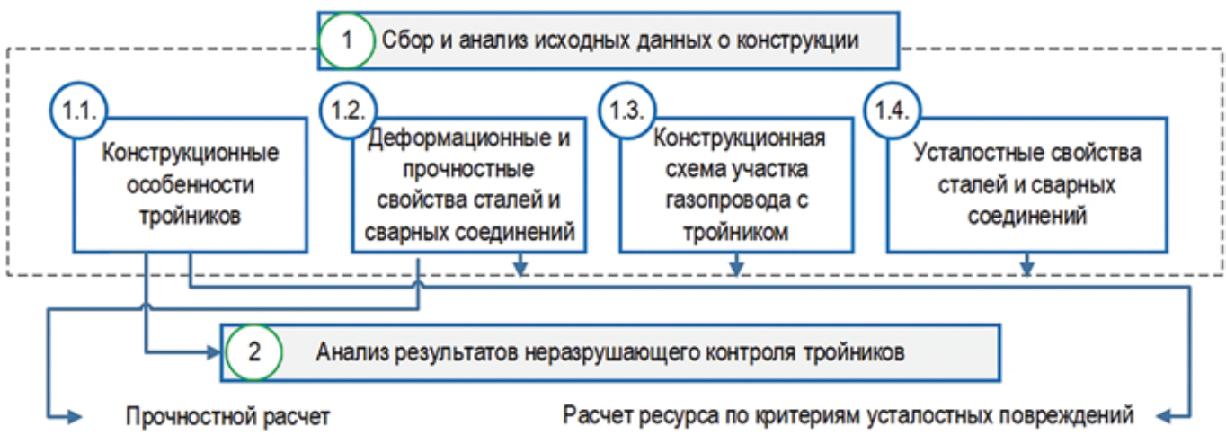
Рисунок 1 – Действующий алгоритм оценки ресурса тройников линейной части магистральных газопроводов (согласно СТО Газпром 2-2.3-453-2010), не предусматривающий использование информации ВТД
