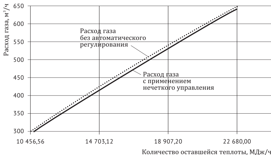
Рис. 4. Зависимости расхода газа от оставшейся теплоты
